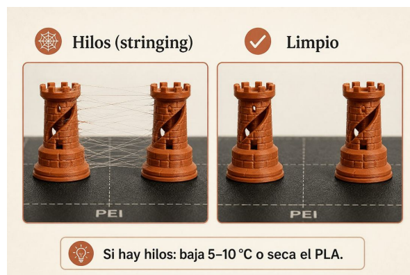
Izquierda: hilos. Derecha: limpio (baja 5-10 C o seca el rollo).
